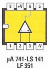
Connessioni viste da sopra degli operazionali uA.741 - LS.141 - LF.351.
